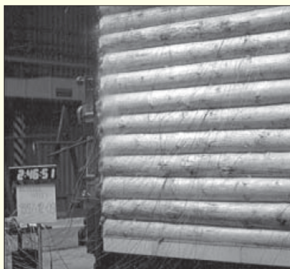
Eksperymentalna ściana z bali wykorzystywana przez Houdeka, zauważalne liczne przewody czujników ciepła na powierzchni ścianki.
