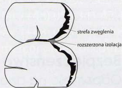
Przekrój przez ścianę z bali po zakończeniu testu. Warstwa izolująca z wełny mineralnej pomiędzy szczelinami rozszerzyła się. Izolacja stworzyła warstwę chroniącą ścianę przed penetracją ciepła
